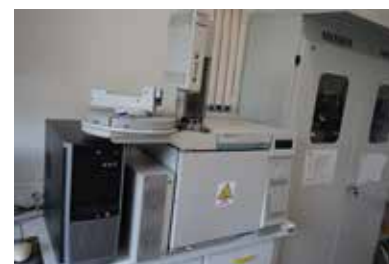
Plinski kromatograf za merjenje hlapnih maščobnih kislin Gas chromatograph for measuring volatile fatty acids
