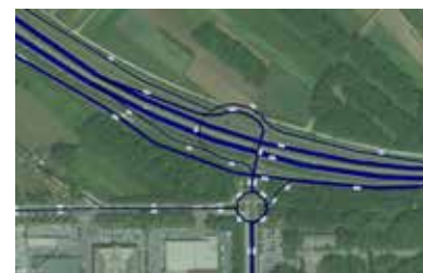
Makroskopski model novega polnega priključka na Leskoškovo cesto – BTC
