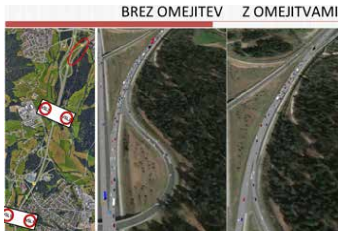
Mikroskopska simulacija z vgrajenimi optimalnimi spremenljivimi omejitvami hitrosti – razcep Koseze
