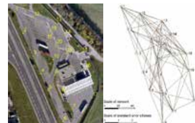
Testno polje (Vipava) z geodetsko mrežo za preizkušanje kakovosti izdelkov, pridobljenih z uporabo daljinsko vodenih letalnikov Test field (Vipava) with a geodetic network for testing product quality, acquired by drones
