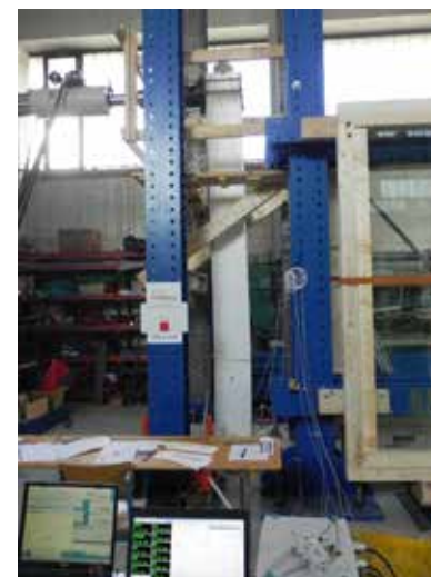
Ciklične preiskave sodobnih dimniških sistemov Cyclic investigations of modern chimney systems
