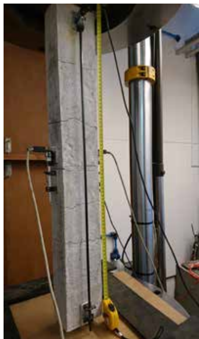
Eksperimentalne preiskave obnašanja natezno obremenjenih armiranobetonskih elementov Experimental testing of the behaviour of stress loaded reinforced concrete elements
