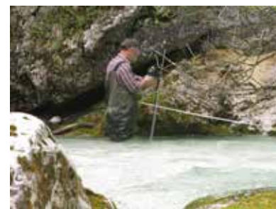
Hidrometrične meritve hitrosti vode Hydrometric field measurements of flow velocities
